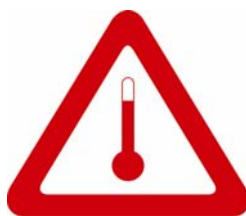
Figura E-4 – Sinalização de substâncias a temperatura elevada
